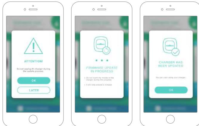
Ten en cuenta que la función de actualización del firmware requiere que el cargador esté conectado a Internet. Se mostrará un mensaje de confirmación al finalizar el proceso.
